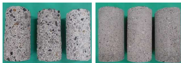
写真1 5%硫酸溶液浸漬28日後のコンクリート供試体の劣化状況 (W/B=60%、20°C養生)
